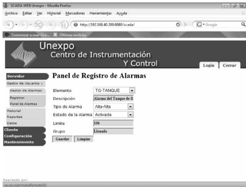
Figura 6. Agregado de Alarma.
