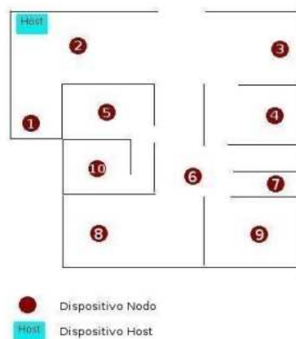
Figura 7. Distribución del Host y del nodo prueba para medir cobertura a 0 dBm.
