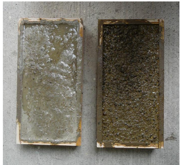
Figura 3. Ensayos de aglomerante cemento con cascarilla de arroz, cacao y bloque macizo de compuesto café, cemento y arena
