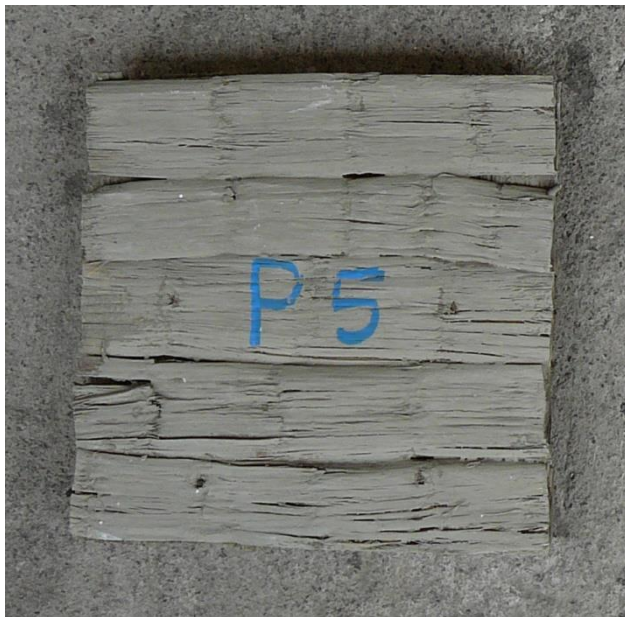
Figura 5. Muestras de paneles aislantes de bagazo para cielo raso aislante o bahareque mejorado
