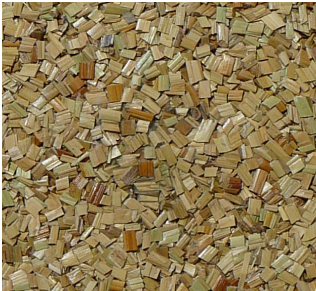
Figura 6. Totora o Typha. Panelado con colas naturales
