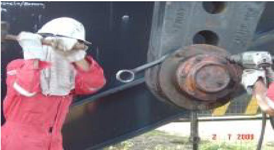
**Figura 3. Procedimiento de desmontaje de los pasadores de manivela en las unidades de bombeo mecánico**
