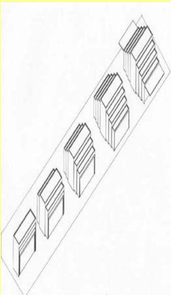
Figuras 7. Vista general del proceso de crecimiento de los módulos que conforman el prototipo de vivienda industrializada, transportable y plegable.
