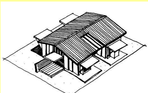
Figura 3. Vista general del prototipo de vivienda industrializada, transportable y plegable con techo de teja de arcilla criolla.
