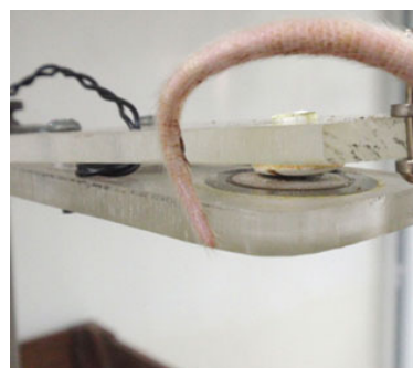
Figura 2: Sistema de Transducción. Disco Piezoeléctrico dentro de la lámina de Plexiglass.
